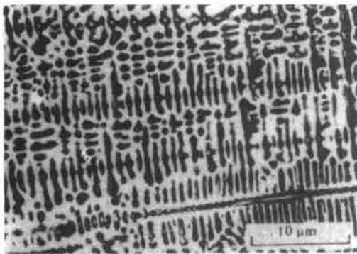
图 1 涂层的 SEM 图像
