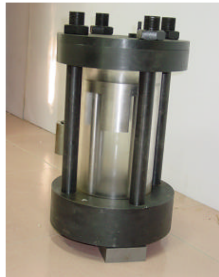
图 2 柔性边界加载试验机实物图 Fig.2 Photo of testing machine
