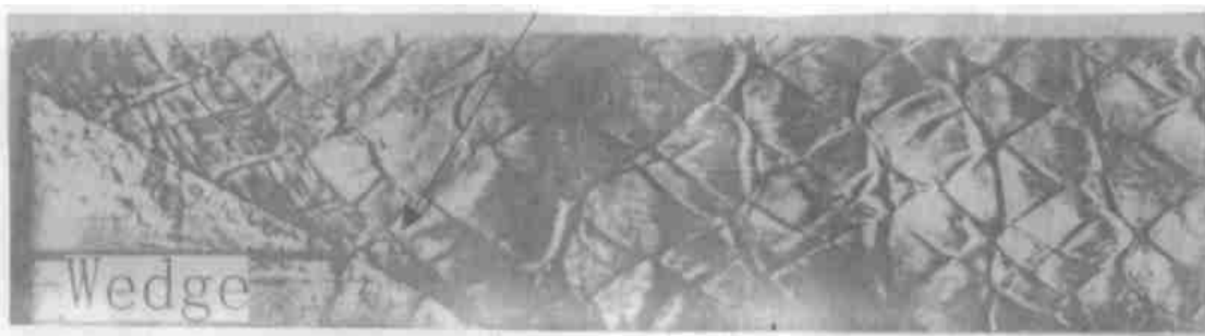
图 9 初压为 16kPa 的爆轰波绕射 26.7 楔块时胞格结构烟迹记录( 2\text{H}_2 + \text{O}_2 + \text{Ar} , \gamma = 1.45 , M_{ej} = 5.12 )
