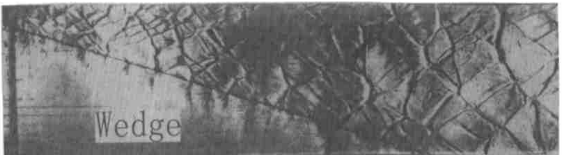
图7 初压为16kPa的爆轰波绕射15.0°楔块时胞格结构烟迹记录( 2\text{H}_2 + \text{O}_2 + \text{Ar} , \gamma = 1.45 , M_{ej} = 5.12 )
