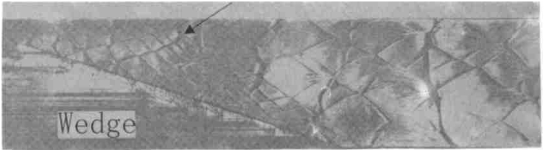
图 8 P_0 = 16 \text{ kPa} , \theta = 19.30^\circ , Mach 反射的胞格结构烟迹记录( 2\text{H}_2 + \text{O}_2 + \text{Ar} , \lambda = 1.45 \mu\text{m} , M_{\text{c}j} = 5.12 ), 三波点迹线在楔块斜面上开始形成
