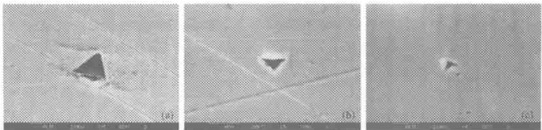
图 6 单晶铜的 3 种压痕及材料表面形貌的扫描电子显微镜照片
