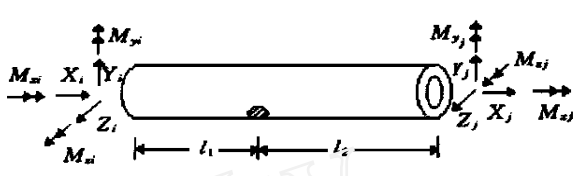
图 1 具有裂纹损伤构件
