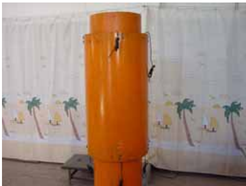
图 1 测量局部应变的套筒式结构模型
