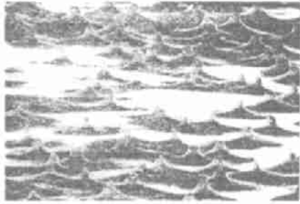
图 2 有机物层中的矿物桥，X 7500
