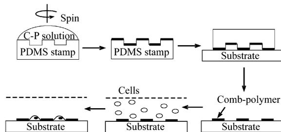
图 1 利用 PDMS 印章和 Comb-polymer 制作微模式化基底过程示意图
