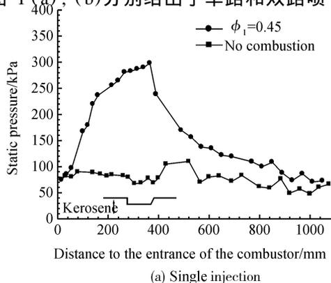
油时燃烧室壁面静压分布,以及凹腔和喷油孔位置。其中,图 1(a)给出的是单路喷油模式下,超临界态煤油在当量比约为  $\phi_1 = 0.45$  时喷注燃烧的壁面静压分布。作为比较,无燃烧时超声速气流的静压分布也在图中给出。从图 1(a)可见,由于燃烧释热,壁面静压有显著提高。同时,燃烧区域(大致为 200 mm  $\times$  400 mm,主要集中在凹腔区)的静压分布并不均匀。这和氢气燃烧时出现的静压近似为等压分布有较大不同。因此燃烧室流动分析中常用的等压燃烧假设<sup>[9,11]</sup>就不再适用。本文对燃烧室流动分析将基于实验测量的静压分布,从而避免了等熵假设、等压燃烧假设等一系列假设,可以提高分析的准确性。图 1(b)给出的是具有双凹腔结构,超临界态煤油从两个喷油点分别以当量比  $\phi_2 = 0.51$  和  $\phi_3 = 0.38$  注入燃烧时的壁面静压分布。
