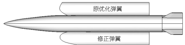
图 11 修正弹翼与原优化弹翼的比较
