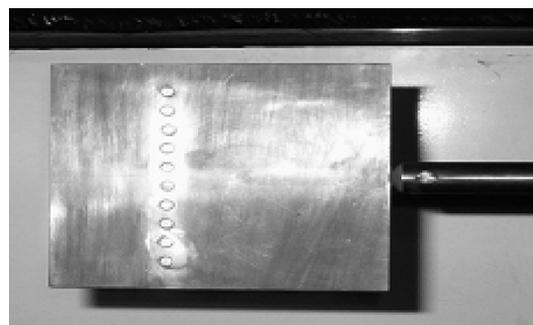
图 2 自由流电子数密度测量平板
