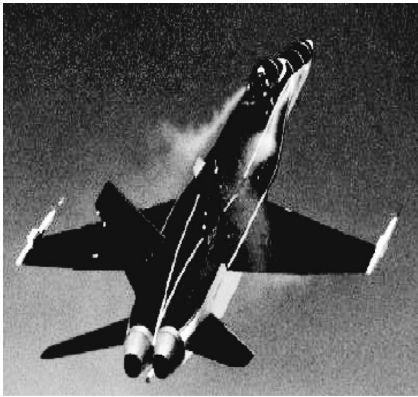
图 6 F/A-18 在大迎角下产生的前缘漩涡 [68]
