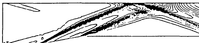
图 8 等压线 ( M_\infty=3 \alpha=5^\circ Re=11 \times 10^6 )
