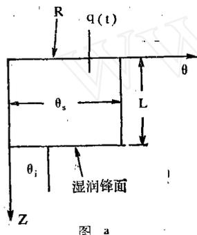
上边界条件应分为二个阶段,一开始由于降雨速率  $R$  小于入渗速率的能力,故入渗率  $q = R$ 。在时刻  $T_1$  时,  $q(t) = R$ ,以后雨率总假定大于入渗速率,故土壤表面有多余的水,但本计算不考虑表面积水,只认为从这以后表面处于饱和水分状态,故上边界条件为:
