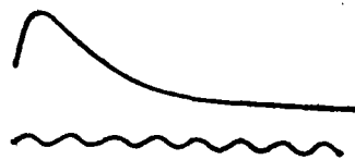
图10 积分法测量长脉冲电流波形
