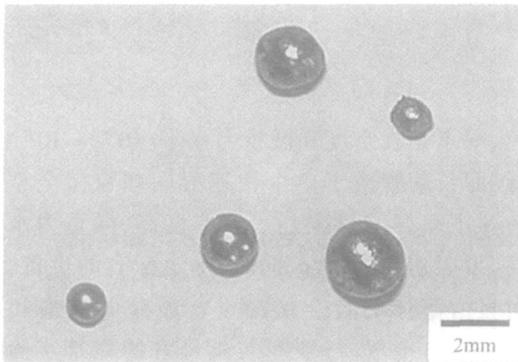
图1 落管凝固合金球体外形照片
