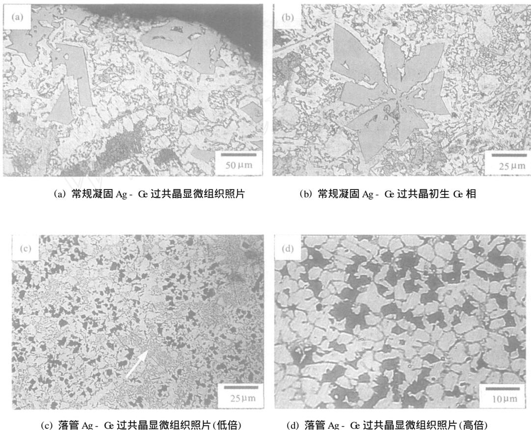
图 3 Ag - 21 %Ge(质量分数)过共晶合金的显微组织照片
