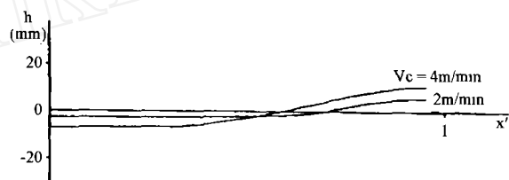
图 4 不同浇铸速度的弯月面形状 ( B_0 = 0.1 \text{ T} )
