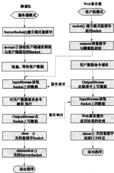
图 4 Web 服务器与上位机通信流程
