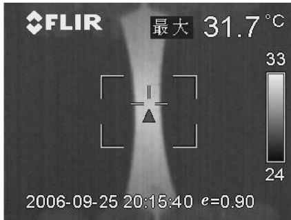
图 4 试验中的 45 钢试样热象图
