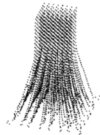
图 3 SPH 计算结果,粒子间距为 0.8 \times 10^{-3} m
