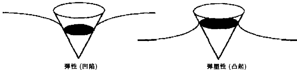
图 3 压痕过程中的凹陷 (sink-in) 和凸起 (pile-up)
