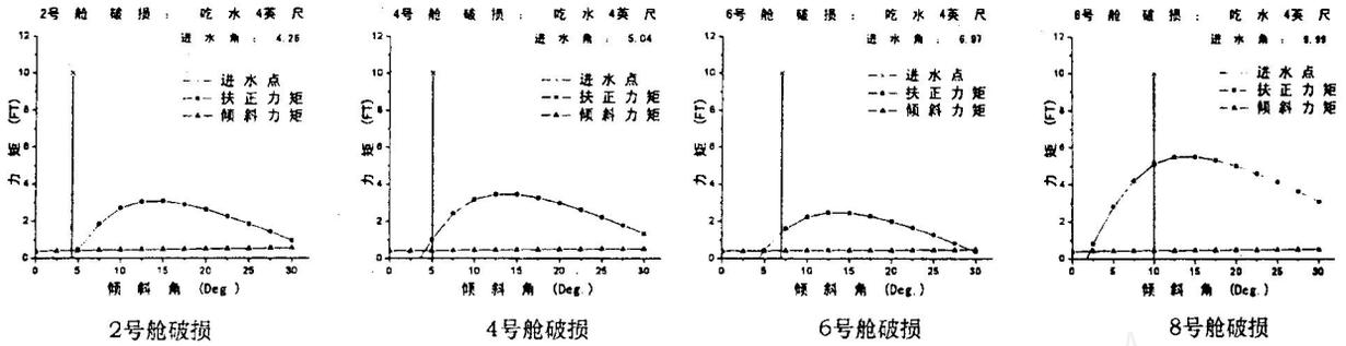
图 8 在吃水为 4ft 时,各舱破损后的稳型
