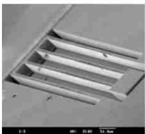
(b) 梁弹簧结构的 SEM 照片 (b) SEM of spring beam structure
