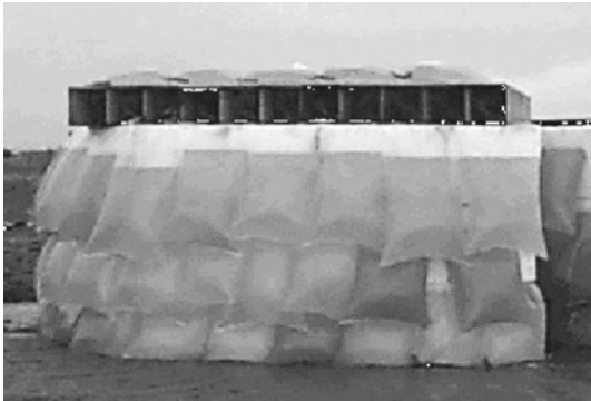
图 1 水幕减爆防护装置 利用水袋覆盖高能装药降低潜在爆炸危害
