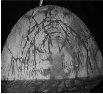
图 6 试样表面裂缝图
