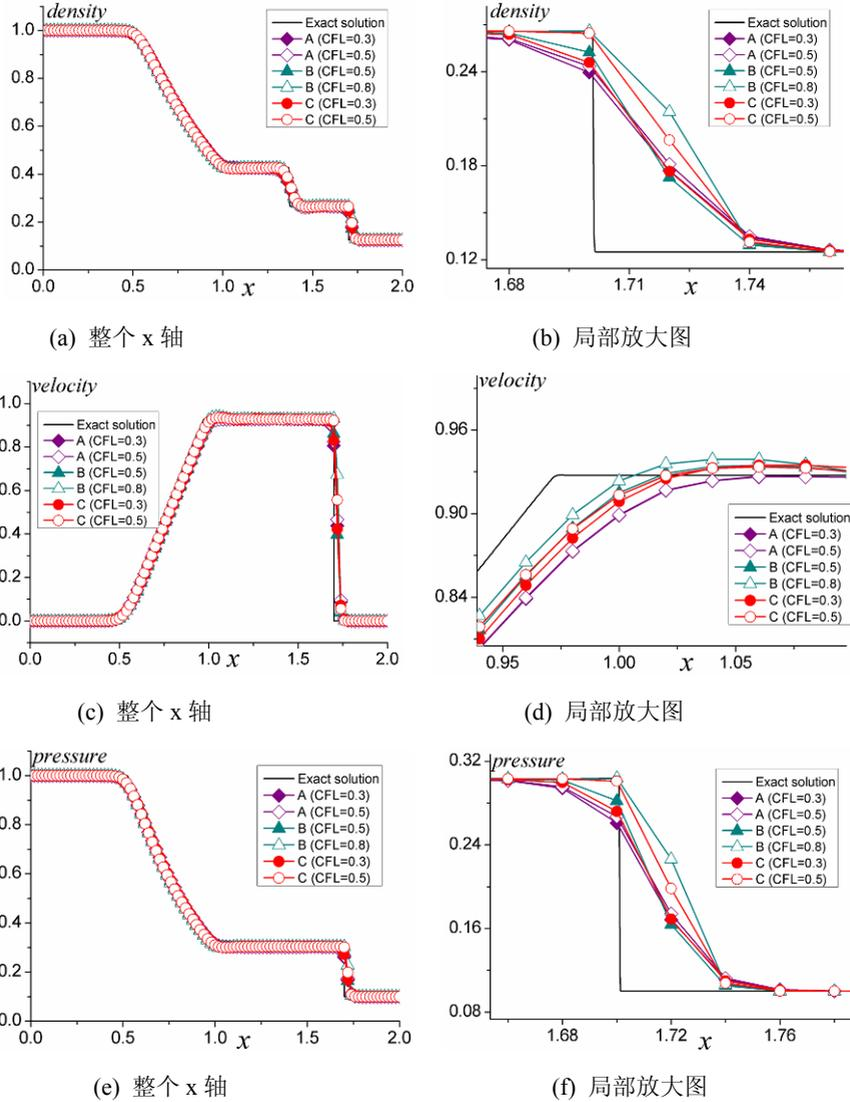
图 2.1.  $t=0.4$  时的数值结果。A 代表 3 阶 ENO 格式，B 代表原始 CE/SE 格式，C 代表本文格式。(a)、(b)是密度分布图，(c)、(d)是速度分布图，(e)、(f)是压强分布图。
