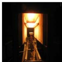
图 3 试件放在辐射光源下加热
