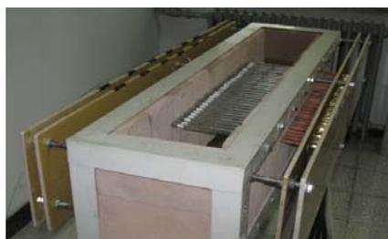
图 1 辐射加热装置
