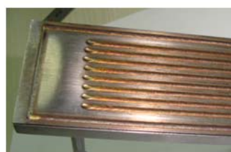
图 25 受压膨胀后的冷却板
