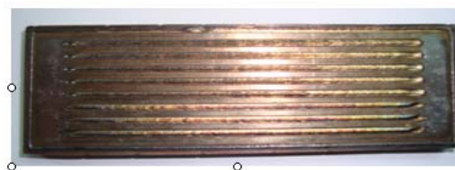
图 24 发动机冷却板焊接
