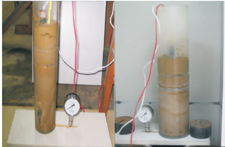
图 8 天然气水合物热分解的分层现象
