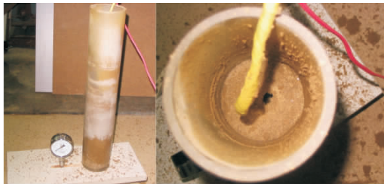
图 9 天然气水合物热分解的喷发现象
