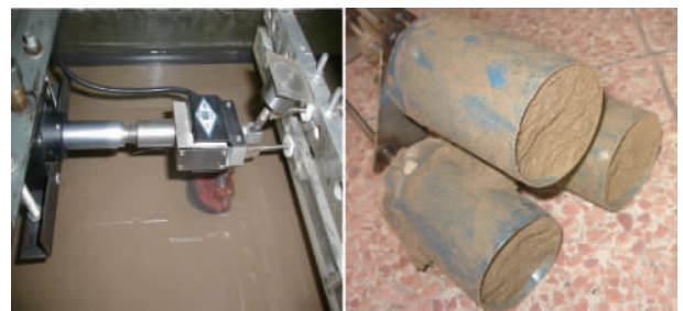
图 6 水平静载下单桶离心模型试验结果和基础内的土塞 Fig. 6 Result of centrifuge model test and the soil plugs in the foundation
