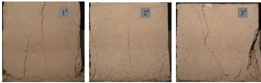
图5 试样冲击破坏结果
