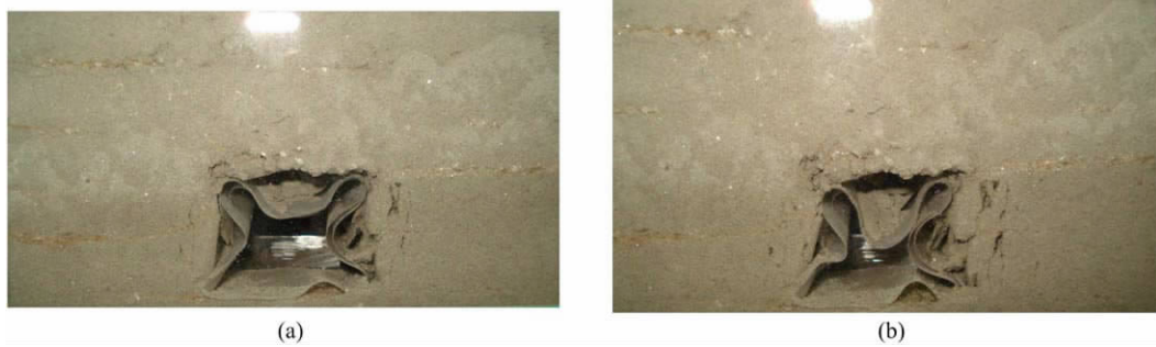
图8 巷道变形破坏图
