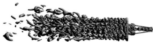
图 10 工况三下的瞬态 Q 等值面图 ( Q=5000 )
