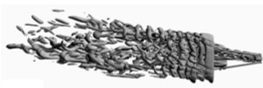
图 11 工况四下的瞬态 Q 等值面图 ( Q=5000 )
