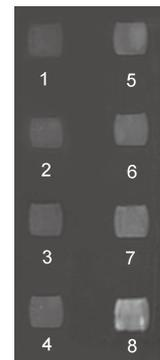
图 4 Anti-AFP 在蛋白 A 分子膜层上装配, 随 anti-AFP 浓度的增加其结合数量越多, 椭偏图像上各单元点的灰度值增加, 1~8 单元点的灰度值分别为 56.4, 62.2, 69.8, 86.5, 94.6, 101.4, 110.6, 118.2
