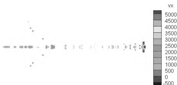
图4 t=100\ \mu\text{s} 时射流速度分布和拉断情况
