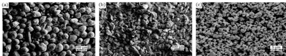
图 3 粉末颗粒形貌。(a) NiCoCrAlY 粉末; (b) ZrO<sub>2</sub> 陶瓷粉末; (c) W 粉末
