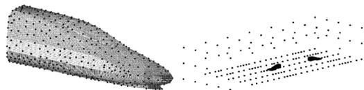
图4 流线型部分及远场控制点分布
