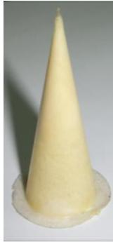
图 7  $10^\circ$  尖锥模型外壳照片
