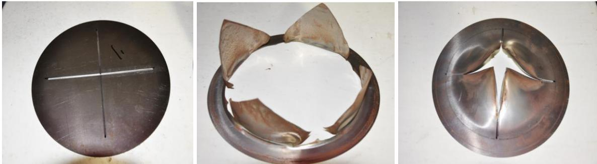
图3膜片 a已开诱导槽的膜片 b破膜后的主膜膜片 c破膜后的喉道膜片
