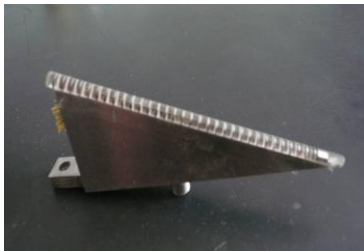
图 8 集成式周向尖翼前缘测热传感器
