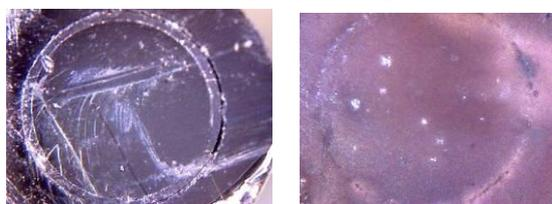
图 4 真空镀膜 (左) 和化学镀 (右) 热电偶端面
