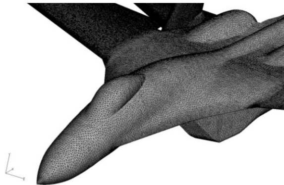
(1b) 某机风洞模型的翼尖及挂架表面网格
