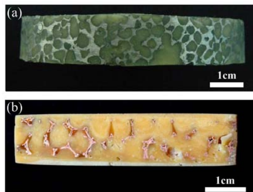
图 1 声子玻璃的光学照片(a) \Phi 56 \times 1 \text{cm} 泡沫铝基声子玻璃(b) \Phi 56 \times 1 \text{cm} 泡沫铜基声子玻璃光学照片
