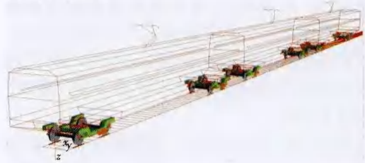
图4 高速列车多体系统动力学仿真模型
