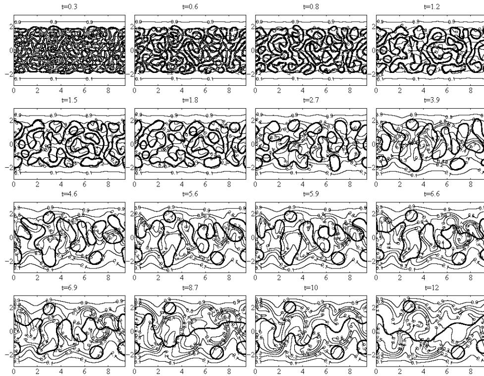
图 5: Re = 50 两相分层过程
