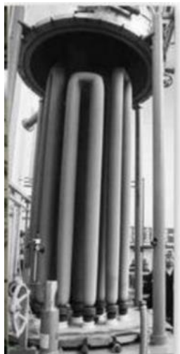
多晶硅提纯CVD反应器
