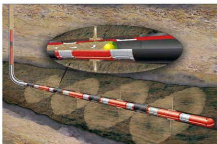
图 1 水力压裂示意图 [2]
