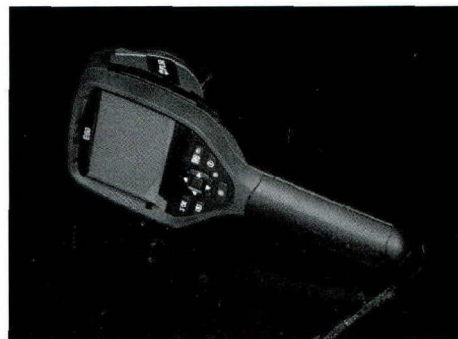
图 3 红外热像仪实物图
