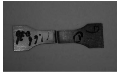
图 11 拉伸试样断裂位置
