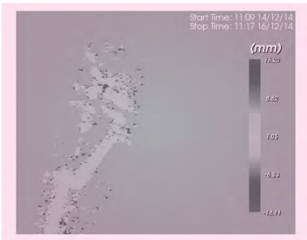
图3 上游坝面及右岸坝肩12月14日~12月16日位移监测成果
