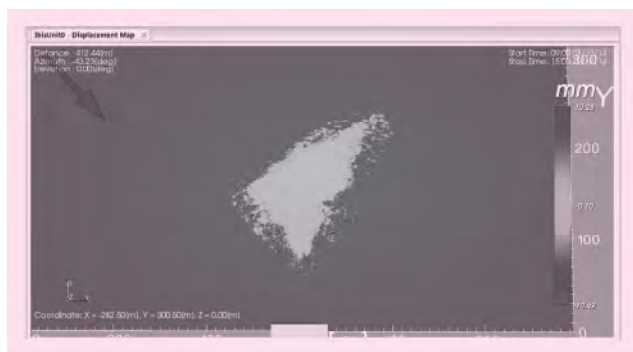
图 1 下游坝面 12 月 8 日~12 月 10 日位移监测成果
